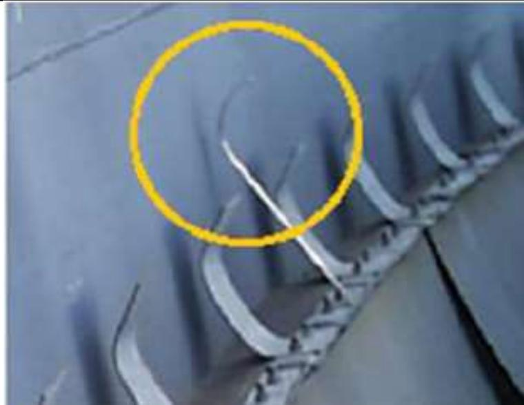
*Shunt* não tendo contato com o costado
