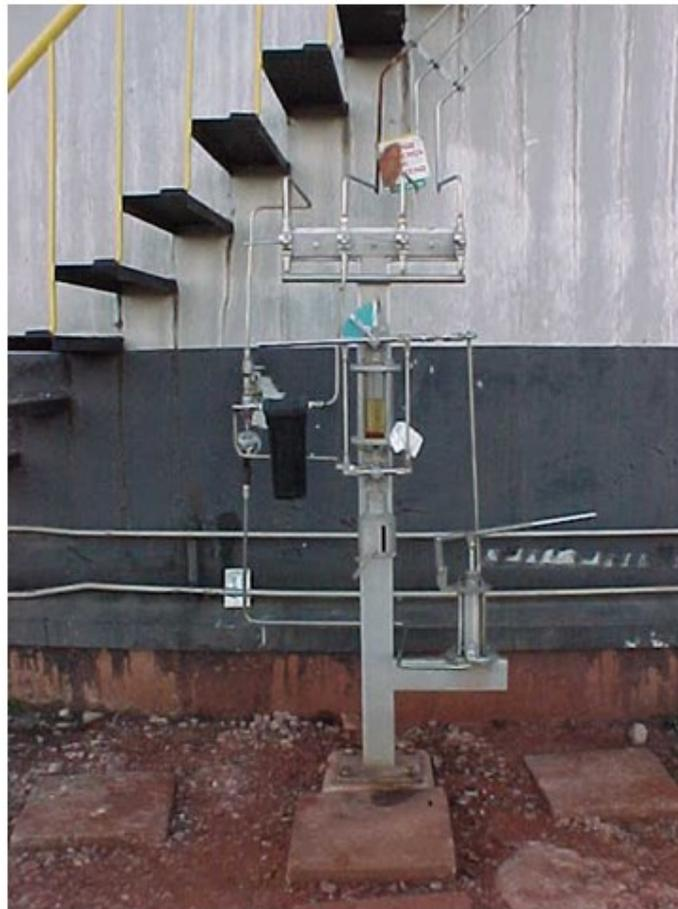
**Detalhe da alavanca que direciona o deslocamento dos pontos de amostragem e a sua coleta na garrafa**
