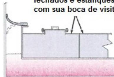
**6. Teto flutuante interno metálico tipo painel sanduíche de Alumínio ou material composto
