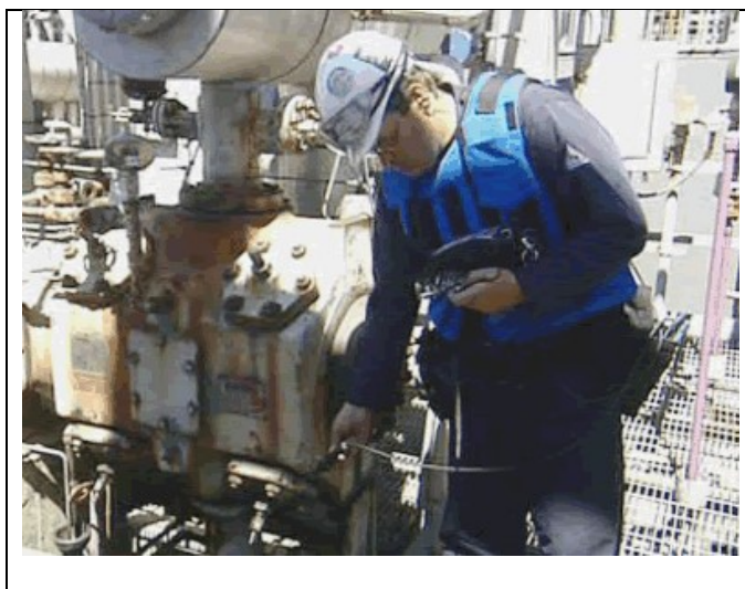
Operador de analisador tipo “sniffers” Estima-se que, em média, um operador treinado pode “cheirar” cerca de 500 pontos em 8 horas de trabalho
