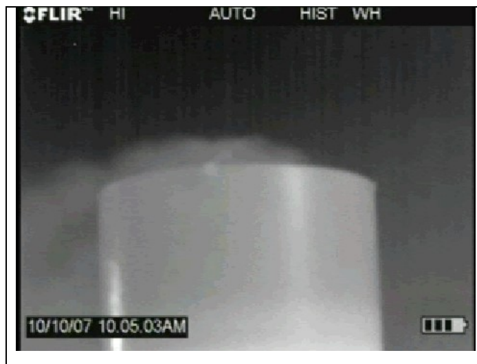
Foto da imagem de câmara infravermelha de emanções ou evaporações de Tanque de Armazenamento
