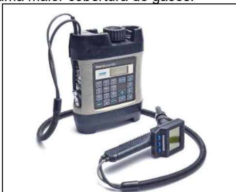
Foto do Analisador de Vapor Tóxico TVA2020 da empresa Thermo Scientific
