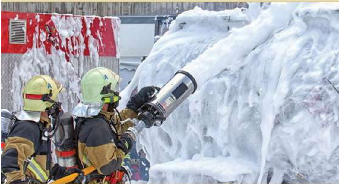
Figura: Mangueira ou canhão monitor portátil com dispositivo lançador de espuma de combate ao fogo
