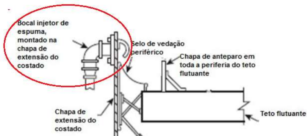
Figura ilustrativa do injetor de espuma em teto flutuante para permitir o combate eficiente do fogo, lançando a espuma, diretamente sobre o selo periférico do teto flutuante
