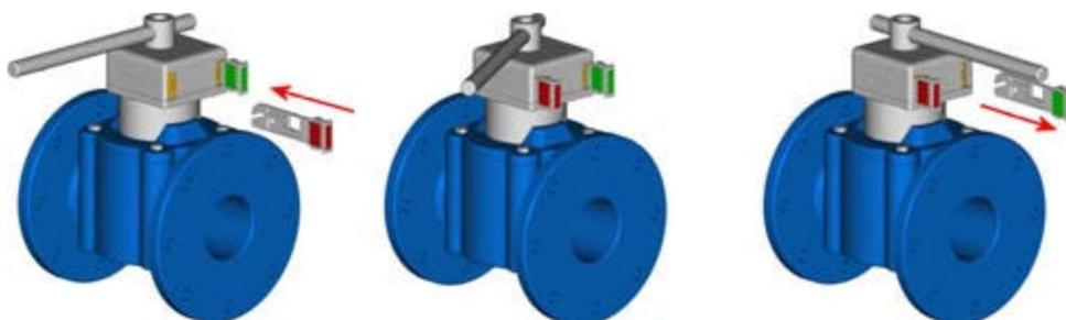
Ilustração da abertura e de fechamento da válvula de bloqueio
