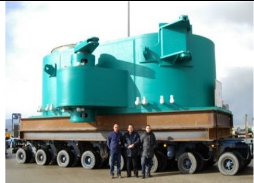
Válvula de desvio tipo diverter valve dos gases de combustão do Regenerador
