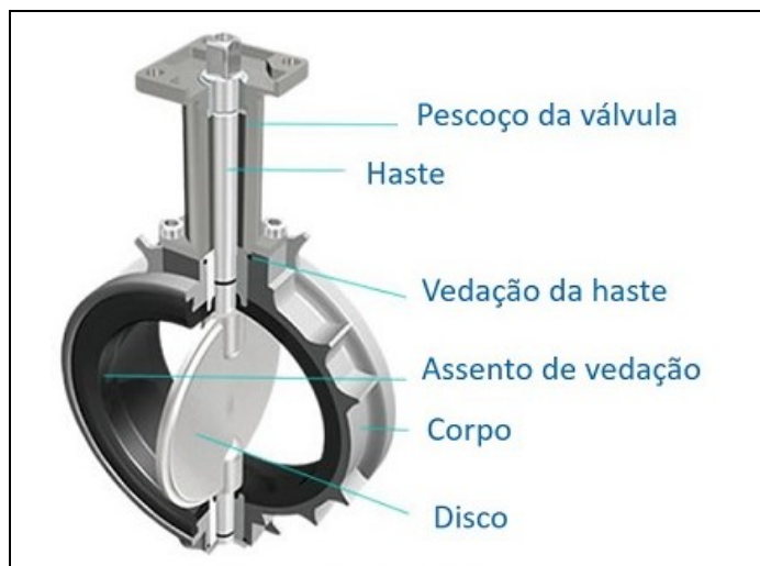
Componentes de válvula borboleta
